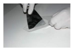
5. Nach dem Aushärten die Polyester Folie entfernen, mit einem Lösungsmittel abwischen und den Gelcoat-Überschuss entfernen
