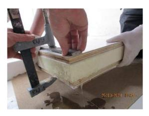
7. Setzen Sie eine zweite Klemme so ein, dass einige an den beiden Ecken der Platte anliegen. Ziehen Sie diese fest.
