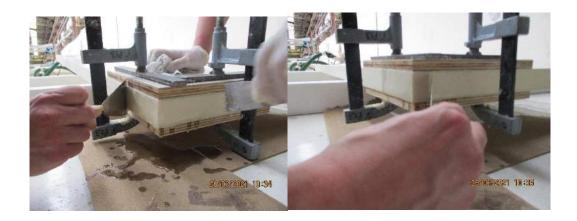
Sobald das Harz ausgehärtet ist (ca. 1 Stunde einwirken lassen), entfernen Sie die Klemmen.
