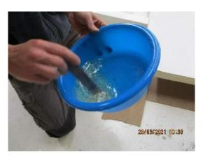
3. Gießen Sie das Peroxid (maximal zwischen 1,5% und 2%) in die Harz/ Faser-Mischung und vermengen Sie das Material
