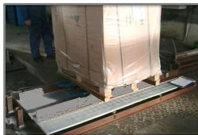
**Festigkeitsprüfung :** wir haben anspruchsvolle Tests auf einem Prüfstand durchgeführt und konnten weder bleibende Verformungen, noch sichtbare Beschädigungen feststellen.
