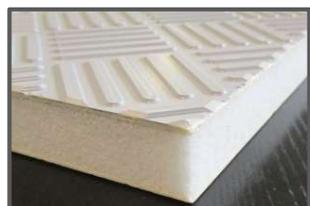
**Kern aus PET-Schaum mit hoher Densität (Polyethylenterephthalat) mit beidseitiger GFK-Beschichtung und einer rutschhemmenden Struktur auf der Oberseite**
