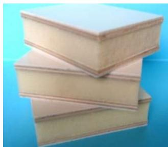
**Kern aus PU-Schaum zwischen zwei Sperrholzplatten von 4 mm mit beidseitiger GFK-Beschichtung**
