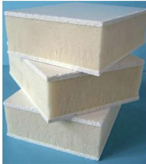
Kern aus PU-Schaum mit beidseitiger GFK-Beschichtung
