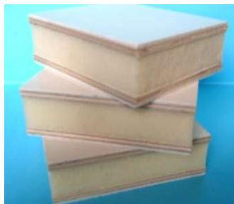
**Núcleo de espuma de poliuretano entre dos contrachapados de 4 mm revestido por ambas caras de resina poliéster armada de fibra de vidrio**
