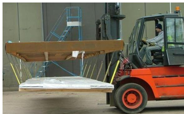
Dans tous les cas de **manutention** et de stockage il faut éviter que les panneaux ne soient griffés lors des manœuvres par des chocs ou des frottements.
