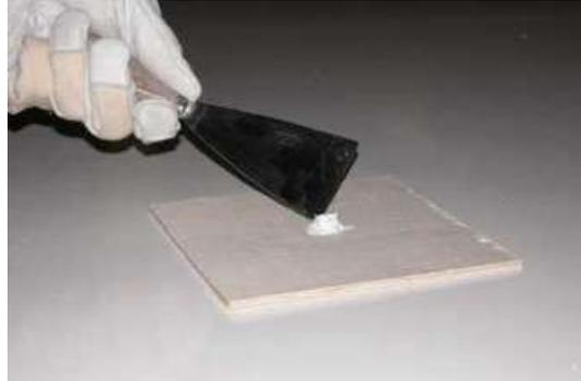
4. Colocar el gelcoat mezclado sobre el defecto, aplicar la película y nivelar con una espátula.
