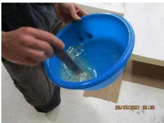
3. Verser le peroxyde (entre 1.5% et 2% maximum) dans le mélange résine + fibre et mélanger
