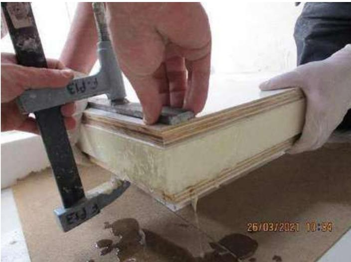
Coloque una segunda abrazadera de modo que haya abrazaderas en ambas esquinas del panel y apriételas.
