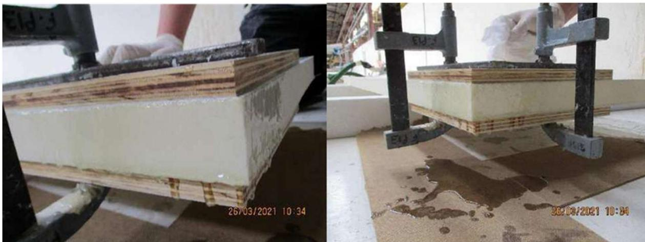
7. Con una espátula, retire el exceso de resina del núcleo del panel.
