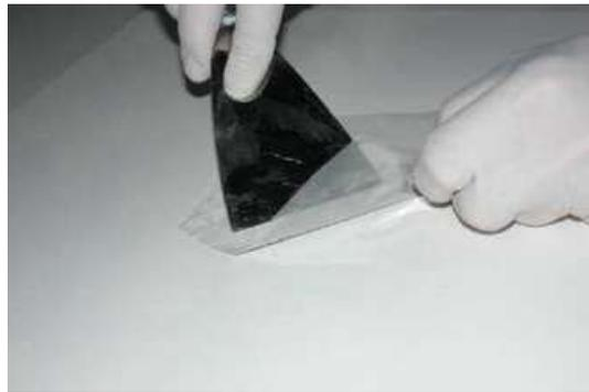
5. Nach dem Aushärten die Polyester Folie entfernen, mit einem Lösungsmittel abwischen und den Gelcoat-Überschuss entfernen
