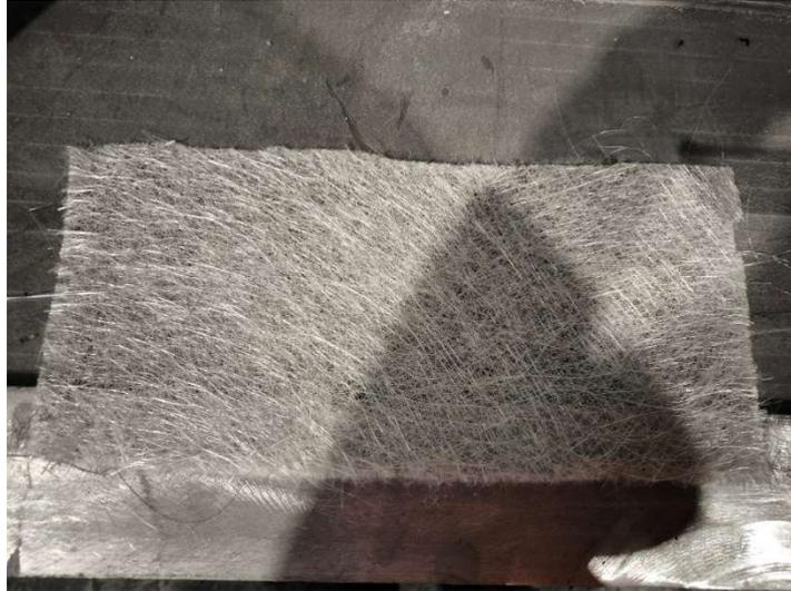
Die Verstärkungen müssen entsprechend der in der Schleifphase vorbereiteten Form vorbereitet und geschnitten werden
