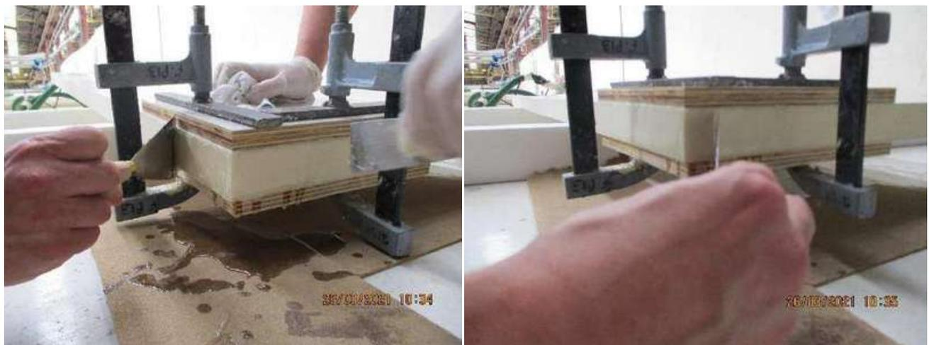
Sobald das Harz ausgehärtet ist (ca. 1 Stunde einwirken lassen), entfernen Sie die Klemmen.
