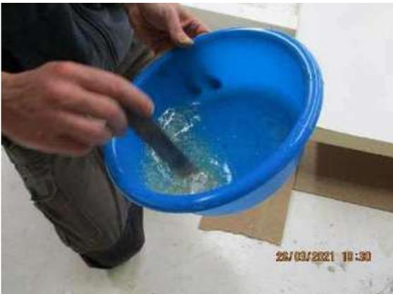
3. Gießen Sie das Peroxid (maximal zwischen 1,5% und 2%) in die Harz/ Faser-Mischung und vermengen Sie das Material
